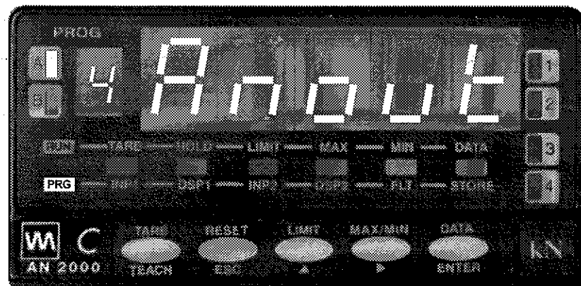
Bild 7-6 : Menü 4A - Wahl des Ausgangstyps
