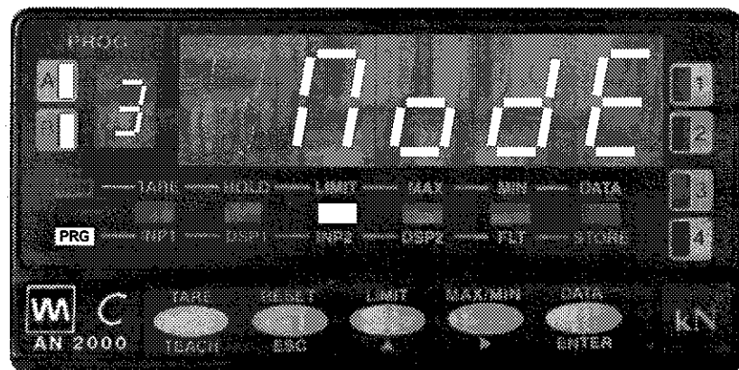
Bild 6-15 : Menü 3AB - Programmierung der Verzögerungs- oder Hysteresewerte
