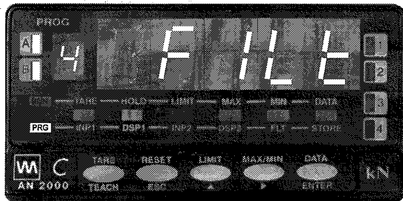
Bild 7-11 : Menü 4AB - Filter
