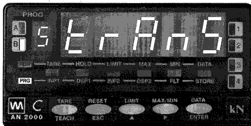
Bild 8-11 : Menü Wahl des Kommunikationsmodus
