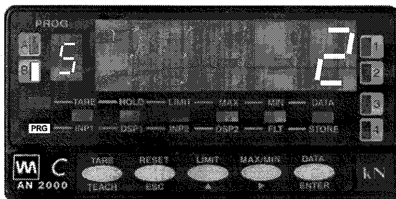
Bild 8-12 : Wahl des Übertragungsmodus
