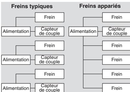
Bei der Herstellung von Mehrfachgeweben oder Litzenkabel, muss die Zugspannung der einzelnen Gewebe oder Litzen gleich gross sein. Erreicht wird dies üblicherweise
